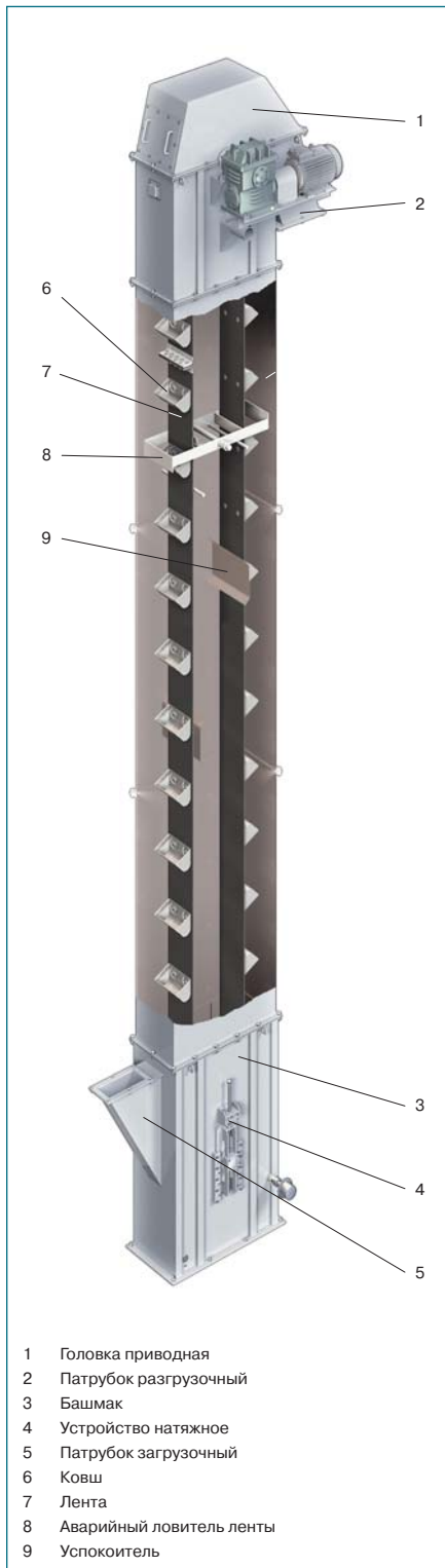
Устройство элеватора ВСЕЛУГ™ КЭ
